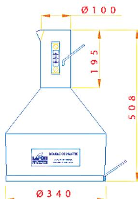
Récipient de contrôle à usage privé d'une capacité de 20 litres.
